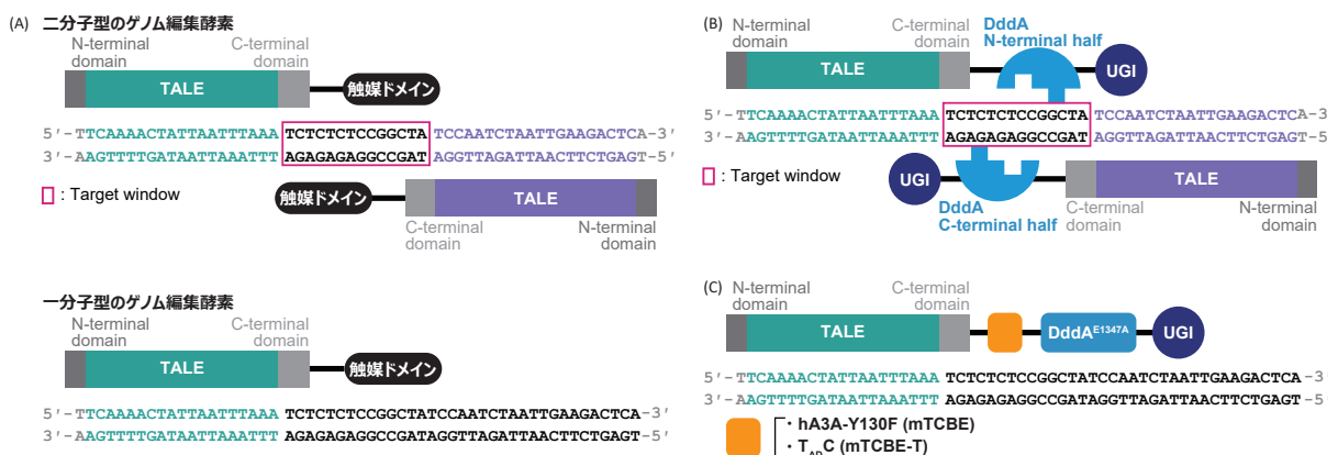
図 1. 葉緑体ゲノム編集酵素の概略図。(A) DNA 結合ドメイン (TALE) が緑色または紫色で表示した標的配列に結合すると、触媒ドメイン (多種類、本文参照) の働きによって target window (二分子型酵素の場合) や TALE 結合配列の近傍 (一分子型酵素の場合) に DNA 二本鎖切断や塩基置換が生じる。(B) cpDdCBE/ptpTALECD の概略図。Nakazato & Arimura 36 を引用。(C) mTCBE や mTCBE-T の概略図。Nakazato & Arimura 36 を改変。
